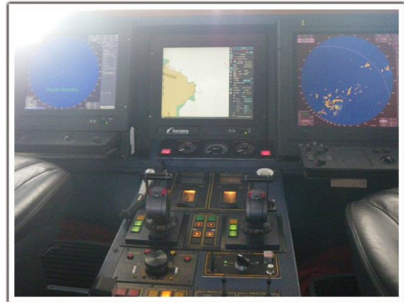
Figura 5. Panel central de mandos del ALGECIRAS JET con los asientos del capitán y el primer oficial, pantallas de radar de babor y estribor y consola ECDIS.
