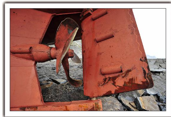
Figura 10. Daños en la hélice del buque MOTXO
