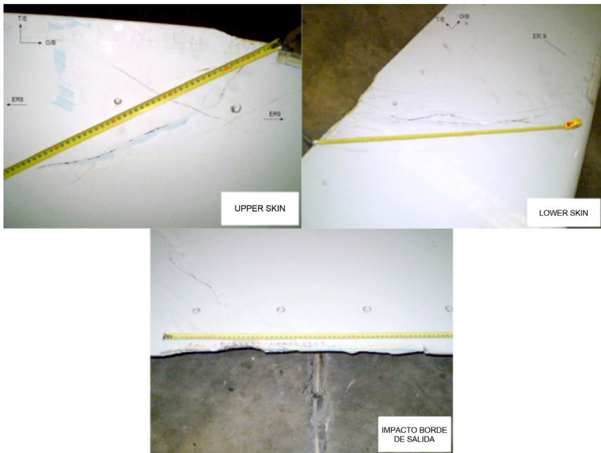
Figura 3. Daños en timón de profundidad EC-JQQ
