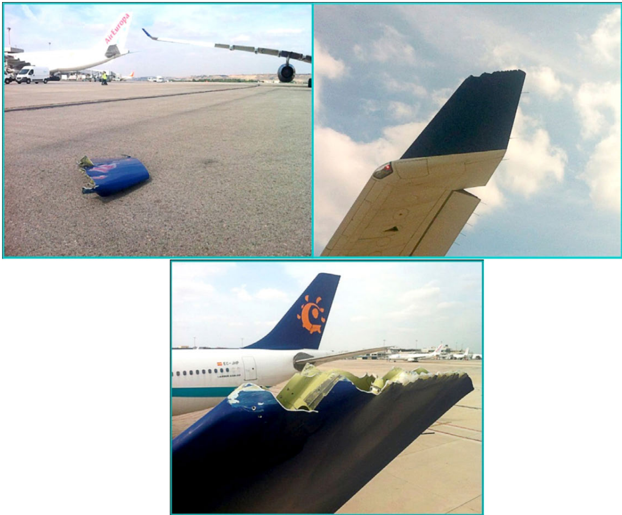
Figura 4. Daños en el «winglet» EC-JHP
