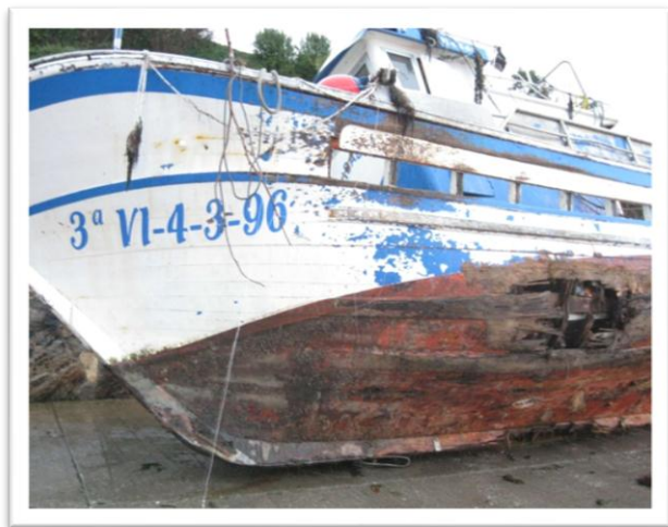
Figura 7. E/P NUEVO ELMO, vista desde proa- babor de los daños sufridos
